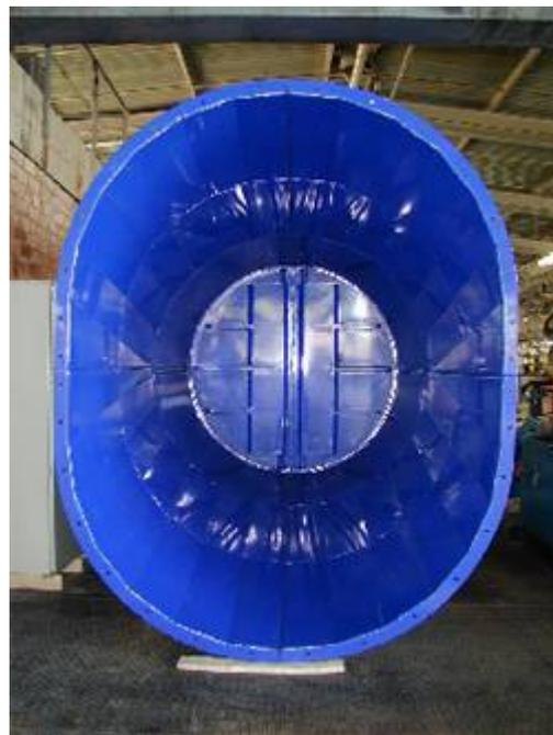
Реверсивный туннельный вентилятор FTDA-REV с круглым клапаном.
