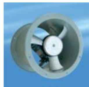
Серия вентиляторов «Аксипал®», выпускаемых ЗАО "Лада-Флект", включает в себя десять размеров (035, 040, 050, 056, 063, 071, 080, 100, 112, 125) с диаметром рабочих колес от 355 до 1250 мм. Производительность в диапазоне 0,5...145 тыс. куб.м/ч при развиваемом давлении 5...1500 Па.
